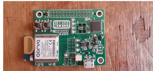
Figure 4. Qorvo (DWM1000) IC Module.
