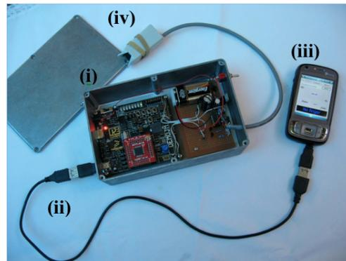
Fig. 2. Oximeter Sensor Prototype
