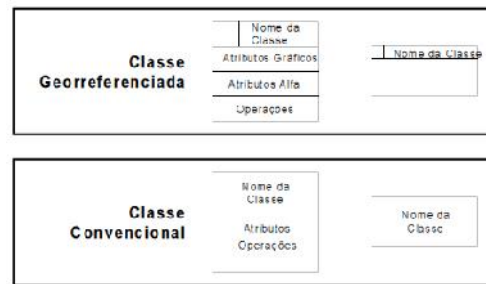
Figure 4. Types of classes and their representations in the OMT-G model. Borges et al. (2001). Legend: Classe georreferenciada (Spatial Class); Classe convencional (Conventional Class); Nome da Classe (Class Name); Atributos (Attributes); Operações (Operations).
