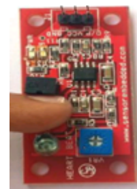
Fig. 7. Heart Rate Sensor
